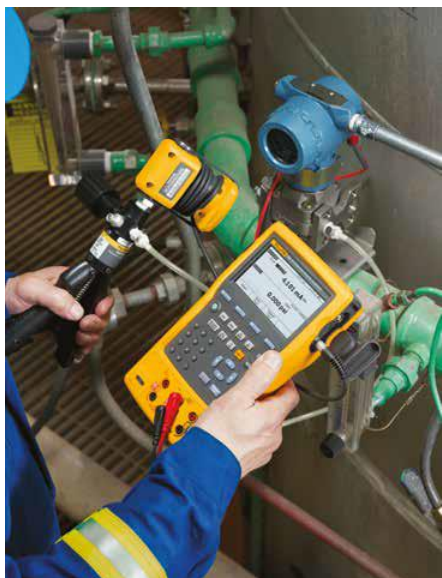
Obr. 1 Ukážka kalibrácie HART prevodníka tlaku pomocou kalibrátora Fluke 754
