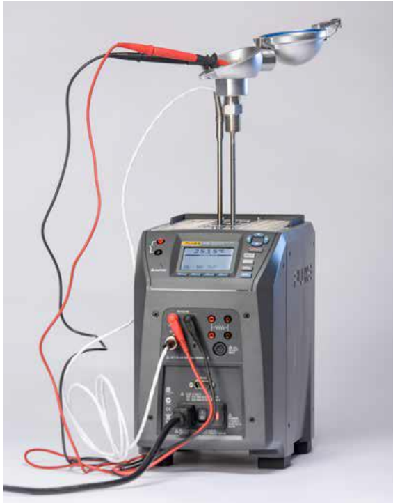
Obr. 4 Ukážka kalibrácie snímača teploty s prevodníkom teploty
