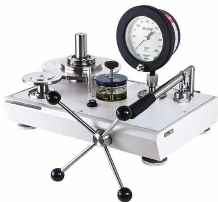
Obr. 2 Ukážka kalibrácie manometra pomocou piestového tlakomera
