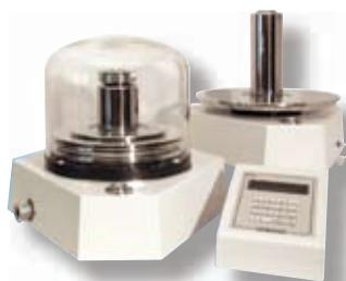
Primární absolutní pístový tlakoměr
