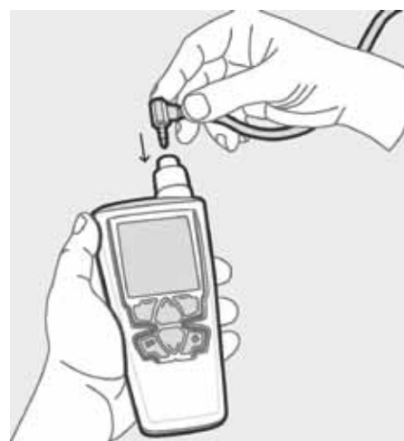
Připojením konektoru sondy k indikátoru HM40 lze zobrazit výsledky měření.
