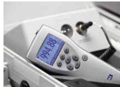
Ruční indikátor zobrazuje běžný tlak v hPa..
