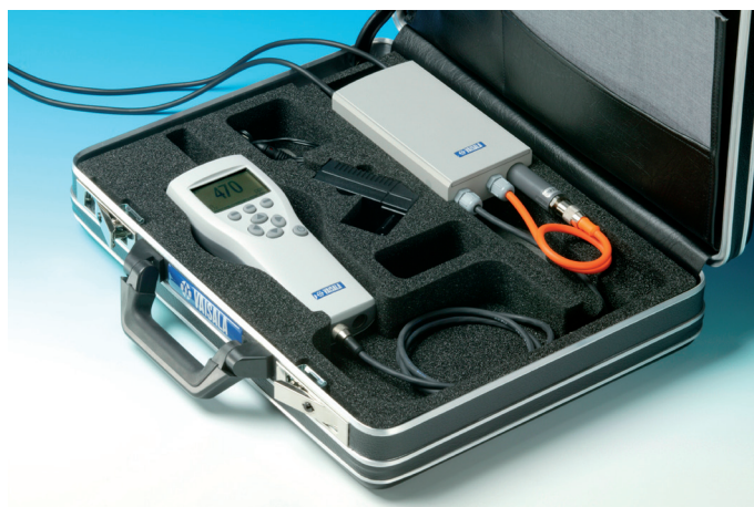
Nasávací pumpa přístroje GM70 se používá např. pro kontrolu provozu inkubátorů.
