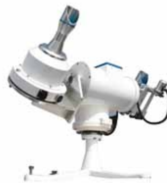
Pyrhelionometr MS-56 a snímač MS-700 DNI jsou namontovány na STR-22G.
